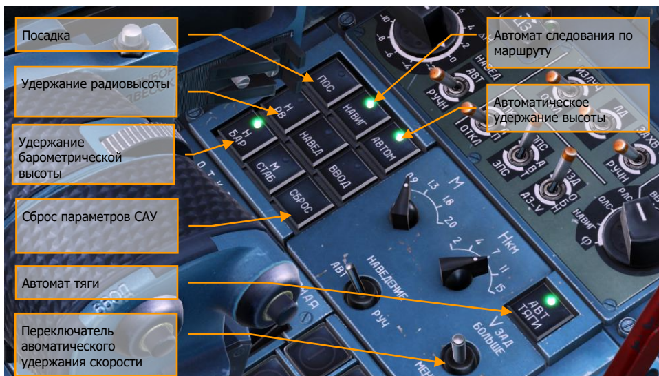
Рисунок 49: Кнопки-лампы CAU
