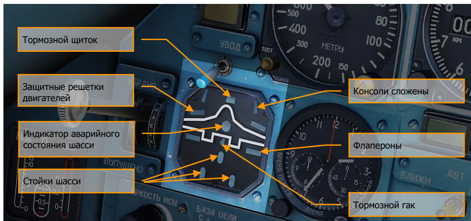
Рисунок 34: Посадочно-пилотажный индикатор
