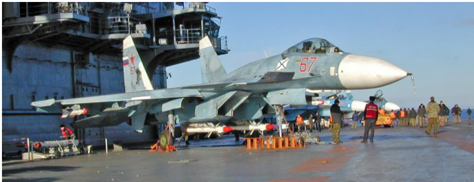
Рисунок 23: Су-33 на палубе Кузнецова с двумя Р-27ЭР под воздухозаборниками и двумя Р-73 под крыльями
